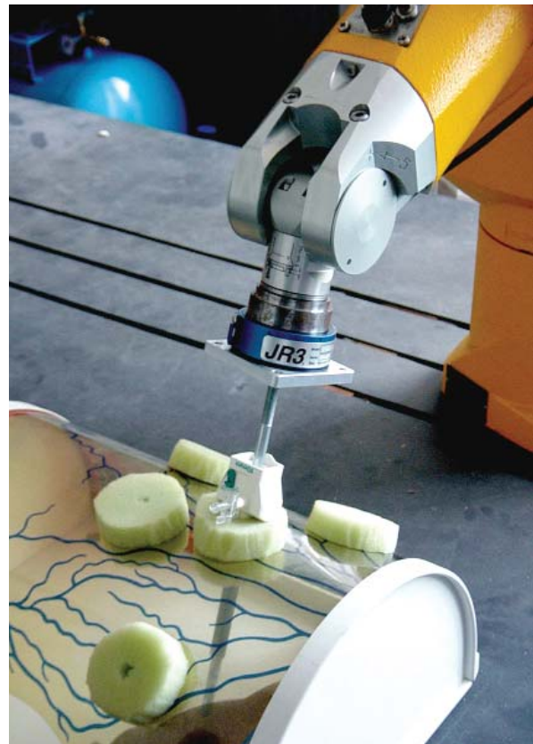
Ryc. 2. Widok robota Staubli RX60 z zamontowanym czujnikiem siły i momentów siły
