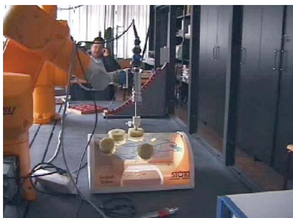
Ryc. 3. Robot Staubli RX60 z zamontowanym laparoskopem oraz modelem fantomowym
