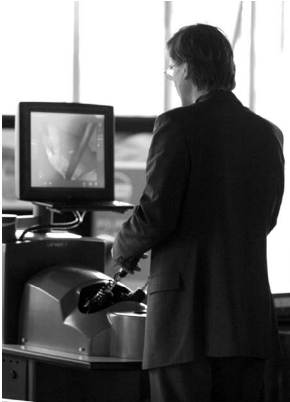
Ryc. 3. Symulatory wykorzystujące rzeczywistość wirtualną pozwalają na ćwiczenie podstawowych umiejętności laparoskopowych oraz naukę standardowych operacji poza salą operacyjną, z dowolną liczbą powtórzeń. Umożliwiają także ilościową ocenę umiejętności oraz analizę popełnionych błędów (LapMentor, Symbionix Corporation, Cleveland, USA)
